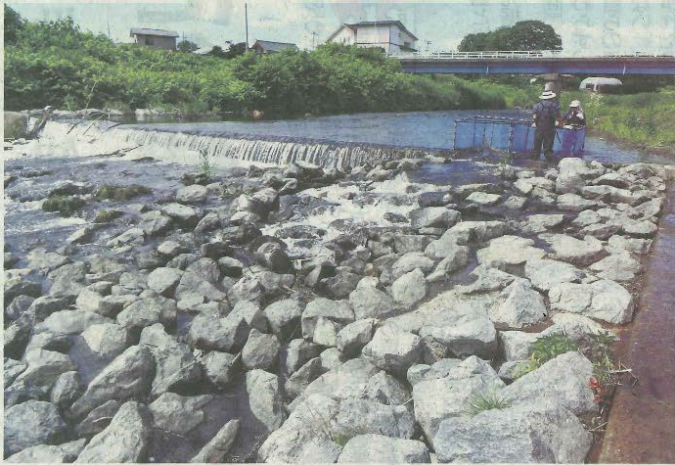
五戸町切谷内で行われた、矢田谷研究室による五戸川の魚道調査。石を敷き詰めた部分が魚道で、その上に網を設置して魚の遡上を確認した11月6日、五戸町
