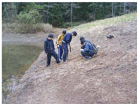
▲全国に約16万カ所あると言われている「ため池」に対する基礎地盤の状況や堤体の損傷度などを調査しています。（森 洋）
