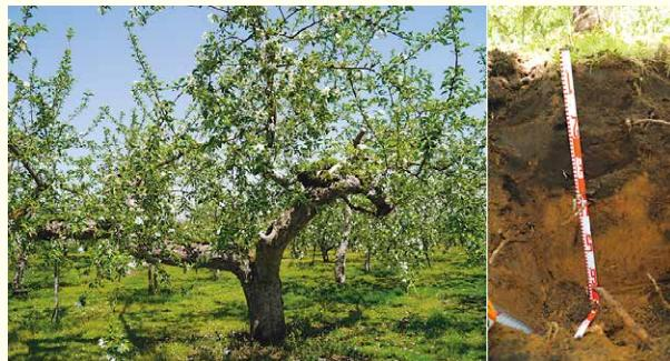
▲リンゴの樹（左）とリンゴ園の土壤断面（右）：果樹園や畠地において、センサを用いて普段は目に見えない土壤中の環境（水分や温度、ガス濃度など）を把握します。観測や実験、数値計算などを通して、例えば気候変動下で土壤環境がどのように変わるか、どのように対処すべきかなどの検討を行っています。（加藤 千尋）
