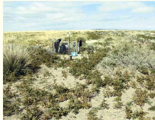
▲モンゴル乾燥地におけるモニタリング調査：乾燥地に自生する甘草（薬草）の栽培化および植生回復による砂漠化防止を目指し、地下水位、降水量、気温、湿度、風速など水収支計算に必要なデータを計測しています。(丸居 篤)
