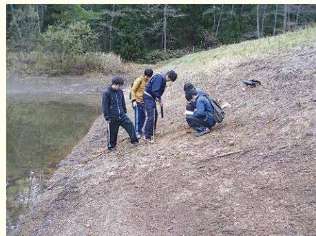
▲全国に約15万ヶ所あると言われている「ため池」に対する基礎地盤の状況や堤体の損傷度などを調査しています。（森 洋）
