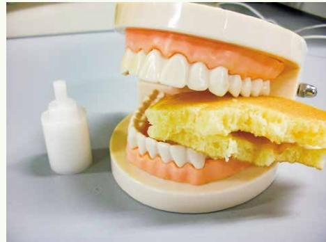
▲食品を噛むモデル（右）と噛んだときのかたさを測るセンサーの先端例（左）：人間が食品を食べるときにかかる力を解析してパンなどの試験法の検討を行っているのみならず、液体の流動性を測って液体内の分子間相互作用を解析する基礎研究に力を入れています。液体の流動性の追跡でどの程度の量の水が液体の食品中に捕らえられているかを推定でき、将来的に食品を食べたときの人間の感覚との対応を明らかにしていきます。（佐藤 之紀）
