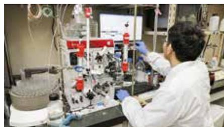
クロマト装置を利用してタンパク質を精製
