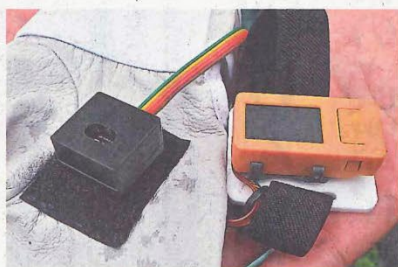
公開されたカラーセンサーの試作機。約1.5センチ角のセンサーで色を読み取り、手首につける本体④に数値を表示する
