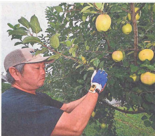
公開されたカラーセンサーの試作機。約1.5センチ角のセンサーで色を読み取り、手首につける本体④に数値を表示する
